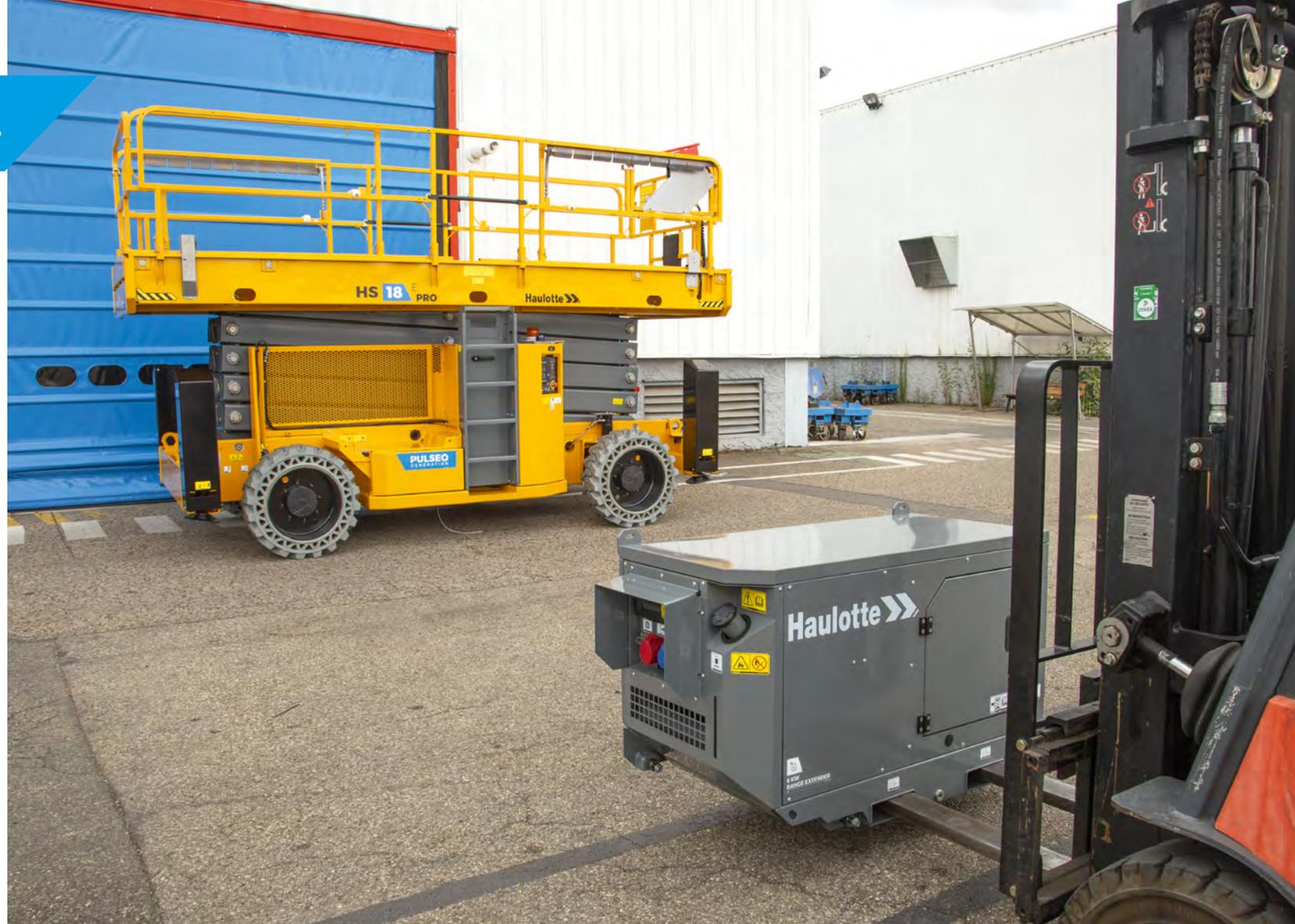
Der Hilfsgenerator gewährleistet auch die Stromversorgung der Steckdose der Plattform.
