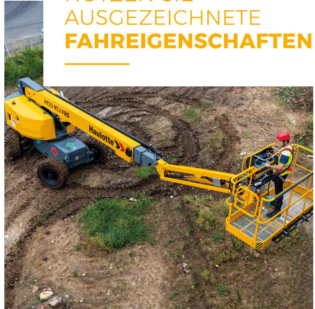
> **Der Carbe-Steer-Mode** ermöglicht Fahrten in alle Richtungen und erleichtert die Zufahrt zur Arbeitszone.
